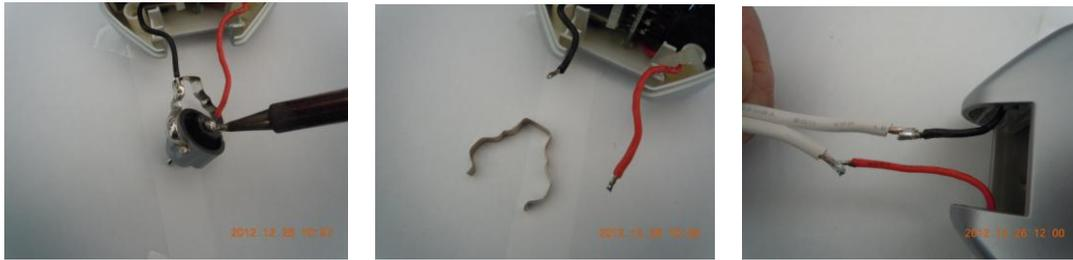
図表 67 ソケット部分のコネクタを取り外し、リード線を半田付け
