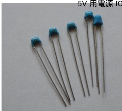
電源・RS232C 用 セラミックコンデンサ
