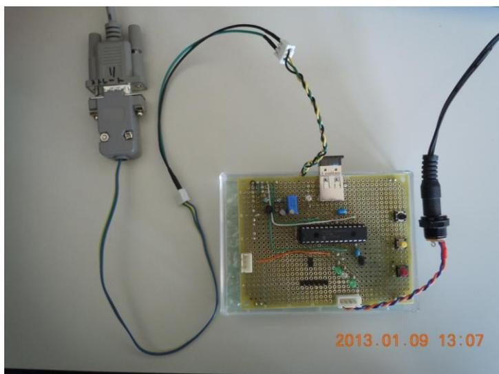
図表 129 シリアル通信のテスト (PC に接続)
