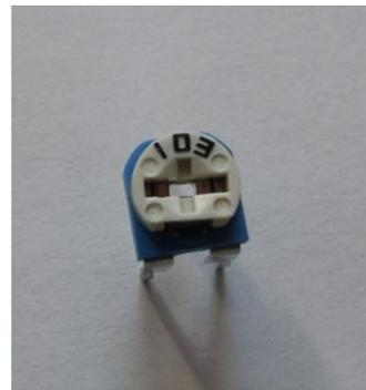
液晶表示器コントラスト調整用 VR
