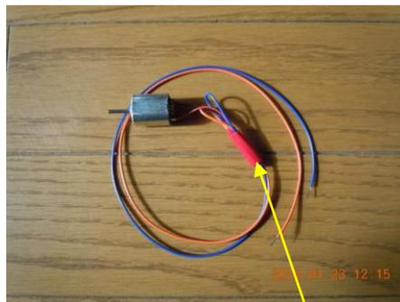
図表 69 PWM 制御実験用 DC モータのリードを延長加工
