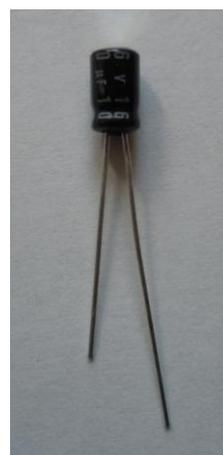
電源 IC 用電解コンデンサ
