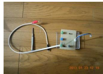
図表 62 鱷口クリップを 1.25φ の線に半田付けして作成
